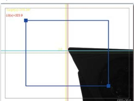
プリセット目標値を画面に表示することができるので、ボーリングバーの径調整が簡単に行えます。
