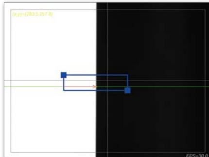
振れ測定をしたい箇所を写し、スピンドルを一回転させるだけで測定できます。
