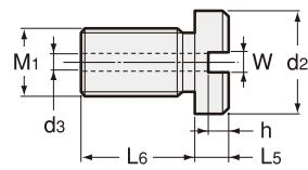
1. L<sub>5</sub>寸法はシャンク内径深さと最低挿入長を確認し選定してください。
