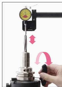
高さ調整ユニットを組み込む事により、六角レンチでホルダ側面に設けた調整ネジを回すだけで刃具突き出し長さの調整を行う事が出来ます。
