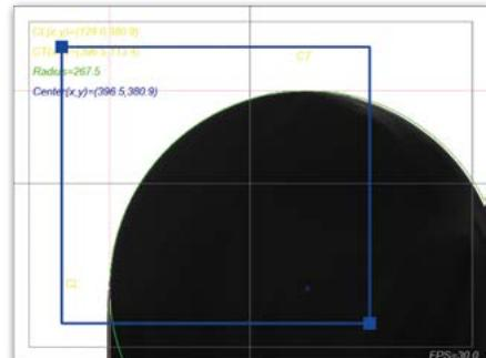
刃物を回転させた時の残像をもとに、測定を行います。ボールエンドミルやタップの形状測定に最適です。
