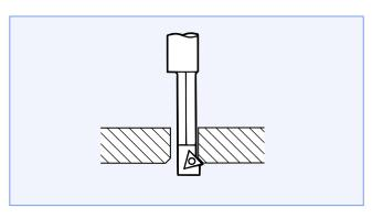
マシニングセンタ・フライス盤等軸補正のできる工作機械での裏面取り。
