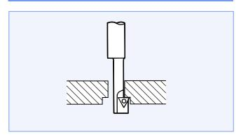
マシニングセンタ・フライス盤等軸補正のできる工作機械での裏座ぐり。
